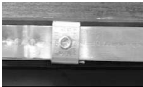
Figura 24 Sello enrollado sobre sí mismo y dentro de la ranura
