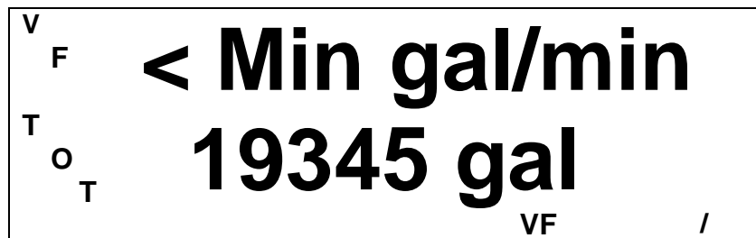
Figura 13 La tasa de flujo es menor que la configuración mínima
