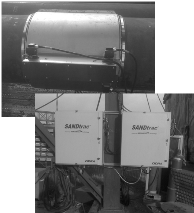
Figura 12 Operación del sistema de monitoreo de perfil de velocidad en las instalaciones de terreno del cliente.
