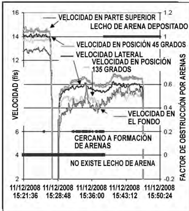
Figura 13 Detección de lecho de arena y desarrollo de lecho de arena en cañería de pulpa en terreno
