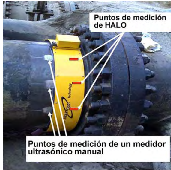
Figura 16: Puntos de medición de espesor de pared de cañería para comparar la técnica convencional con HALO™
