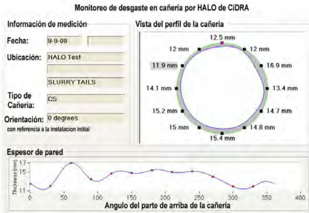
Figura 18: Visualización de espesor de pared de cañería obtenida del software de HALO™
