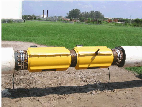
*Cabezas de Sensores Sin Aislación y Bandas de Conexión a Tierra Instaladas*
