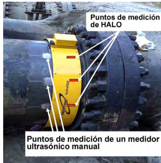
Figura 13: Puntos de medición de espesor de pared de cañería para comparar la técnica convencional con HALO™
