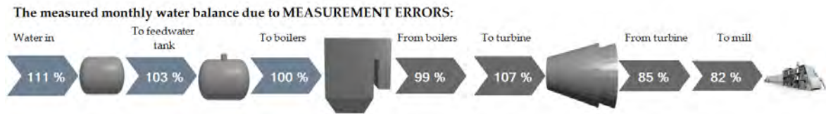
Figura 2 El balance hídrico mensual de una planta de generación de energía muestra el efecto de los errores de medición.
