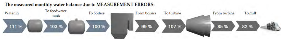
Figura 2 El balance hídrico mensual de una planta de generación de energía muestra el efecto de los errores de medición.
