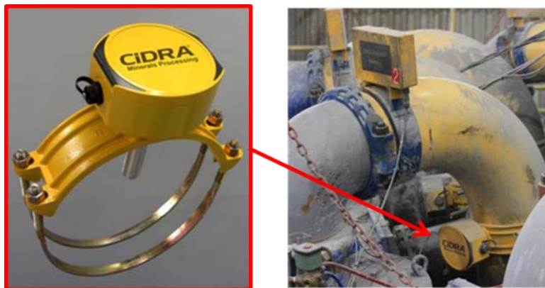
Figura 7 – Izquierda, sensor CYCLONEtrac PST. Derecha, sensor CYCLONEtrac PST instalado en la tubería.
